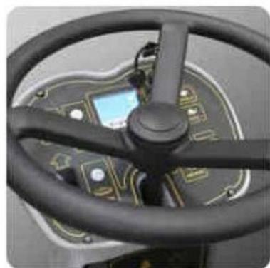
Nuovo pannello di controllo con comandi e display digitali. Display digitale: con contatore, indicatore del livello di carica della batteria, spia del serbatoio vuoto e indicatore di trazione in avanti/indietro. Regolazione della velocità, clacson, interruttore del motore di aspirazione con ritardo di spegnimento.
