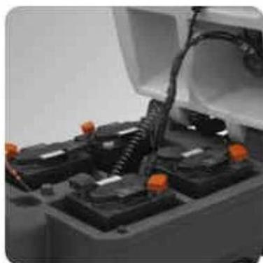
Il serbatoio soluzione detergente serve anche da scomparto batterie, consentendo l'alloggiamento di batterie di elevata capacità che garantiscono tempi di lavoro in continuo fino a 4-5 ore. Serbatoi in polietilene ad alta resistenza agli urti e agli acidi e di ampia capacità (110 lt.), che evita frequenti soste per il riempimento.
